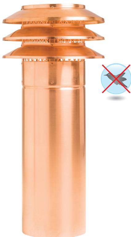
Studiato per agevolare il convogliamento e la dispersione nell'atmosfera dei fumi freddi, provenienti principalmente da cappe di aspirazione e da ventole per aerazione, anche di sottotetti ventilati. Viene rifinito con alette per una migliore protezione dagli agenti atmosferici e con una rete che impedisce l'intrusione di volatili, piccoli animali, foglie e rami.
