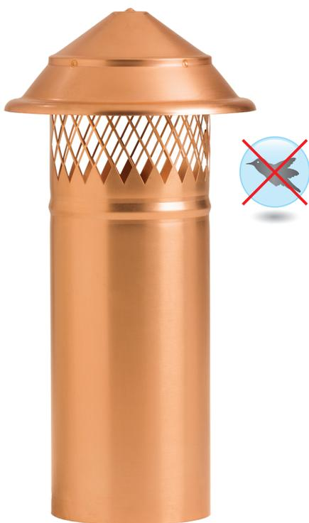
Studiato per agevolare il convogliamento e la dispersione nell'atmosfera dei fumi freddi, provenienti principalmente da cappe di aspirazione e da ventole per aerazione, anche di sottotetti ventilati. La finitura con la rete impedisce l'intrusione di volatili, piccoli animali, foglie e rami.
